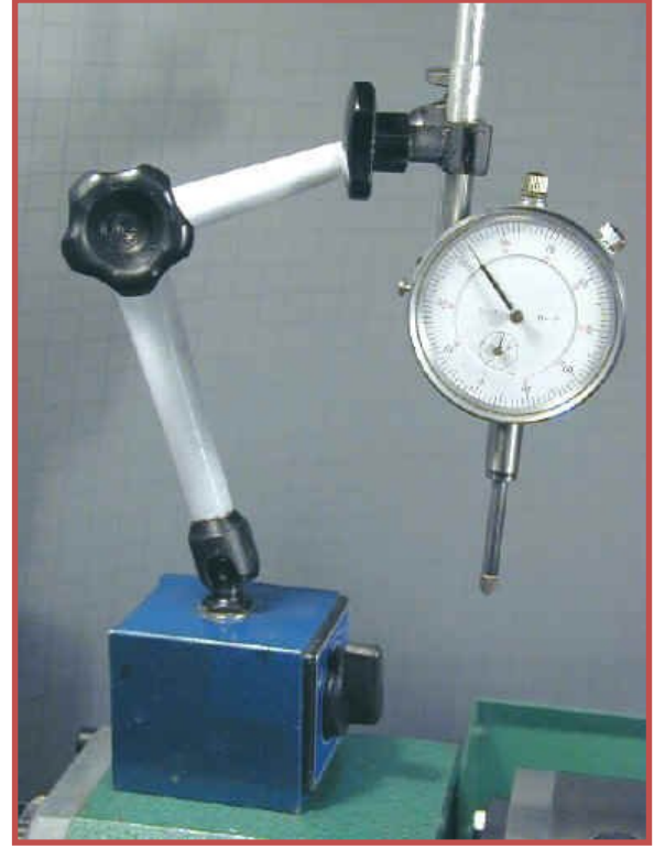
Komparatör ve ölçü saatlerinin parça uygulamalarında kullanılan sehpa ve ayakları
